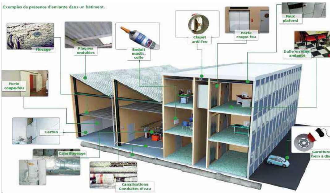
Exemples de présence d'amiante dans un bâtiment.
